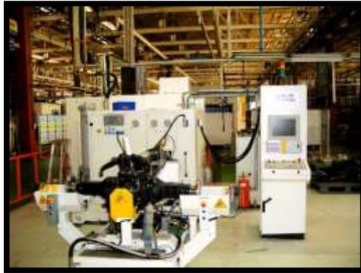
Per la gestione dell'olio da utilizzare per i tests da fare sulla driveline è stata installata una centrale che al massimo può alimentare 4 banchi prova.
